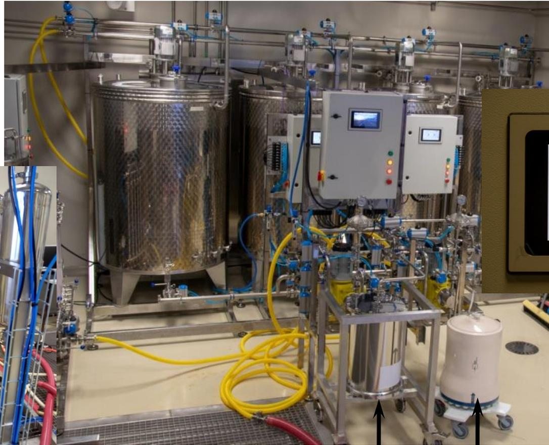
Pilotni HPLC s puferskim sistemom in UV detektorjem
