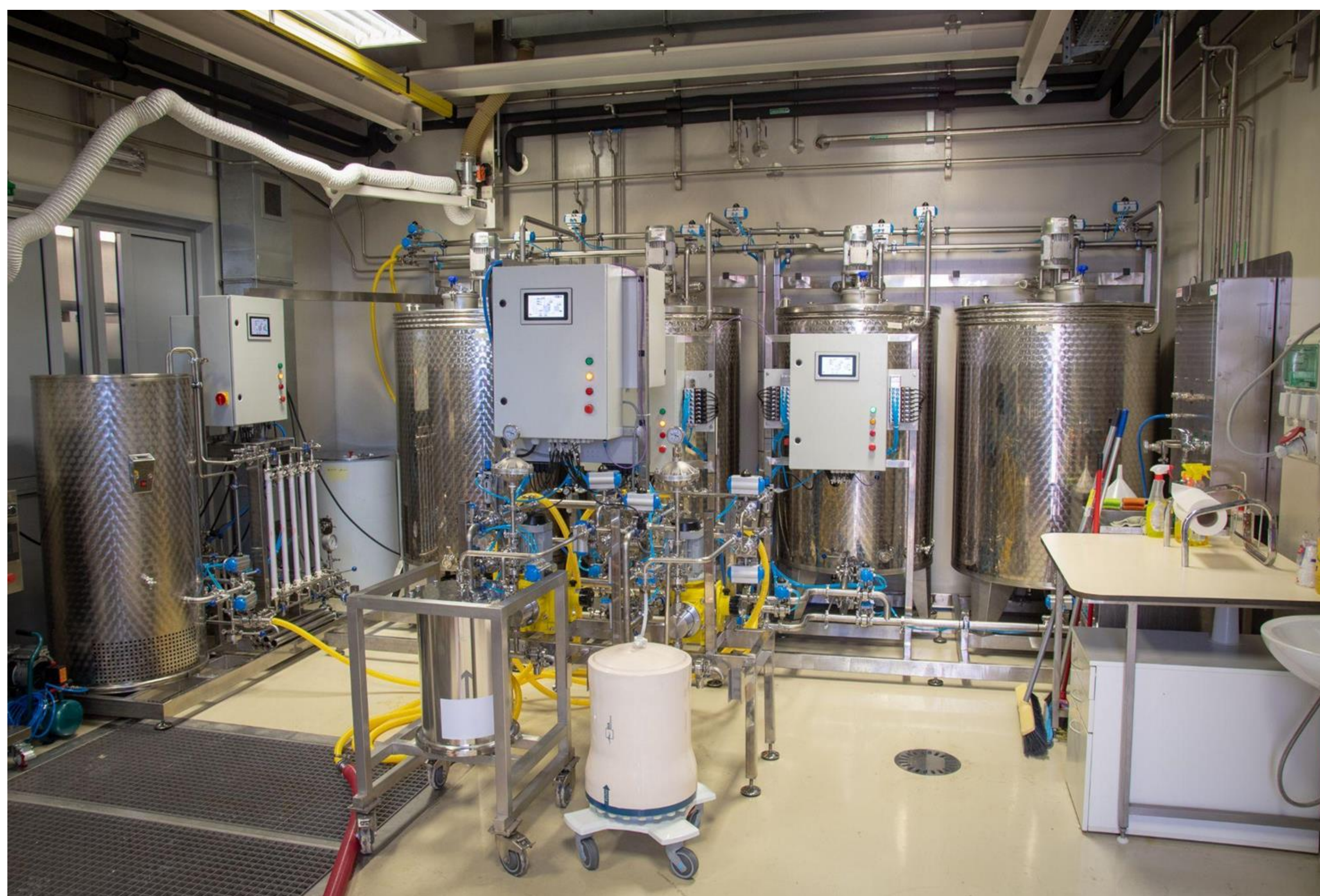
Slika/Figure 1: Pilotni kromatografski sistem sestavljen iz pufernega sistema, črpalk in 8L CIMmultus 8L SO 3 kromatografske kolone. / Pilot chromatographic system consisting of a buffer system, pumps and an 8L CIMmultus 8L SO 3 chromatographic column.
