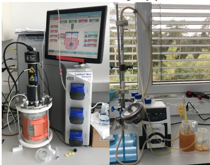
Slika 1: Steklena bioreaktorska posoda z regulacijo pH vrednosti med fermentacijo (levo) in laboratorijski filtracijski sistem za mikro in ultrafiltracijo (desno).
